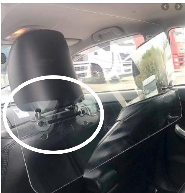
Detalle sujeción de la mampara al vehículo mediante brida
